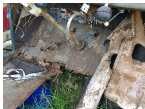
Démontage et découverte de l'état réel du châssis
